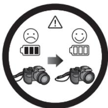
如偶然遇到电池耗电结束但镜头尚未完全收回状况，更换充满电的电池即可，并注意保护镜头，避免撞击磕碰。
