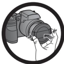
不使用相机时，务必关闭电源。在将相机放入相机包之前，确保镜头已完全缩回，并且盖上了镜头盖。长时间不使用相机时，应从相机中取出电池并妥善存放电池。
